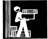
Abdecken der nicht beweglichen, aber brennbaren Gegenstände, die im Gefahrenbereich vorhanden sind (Holzbalken, Holzwände und Holzfußböden, Maschinen- und Kunststoffteile) mit Hitzeschutzdecken, Hitzeschutzplatten, feuchten Segeltuchplanen und ähnlichen Mitteln.
