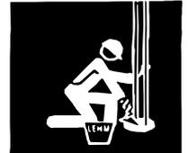
Entfernen von Umkleidungen und Isolierungen aus dem Gefahrenbereich bei Arbeiten an Rohrleitungen, Kesseln und Behältern.
