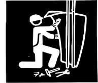
Abdichten der Öffnungen, Fugen, Ritzen, Rohrdurchführungen und offene Rohrleitungen, die von der Arbeitsstelle in andere Räume führen, mit nicht-brennbaren Stoffen. Geeignet sind z. B. Gips, Mörtel, feuchte Erde oder Lehm. Lappen, Papier oder andere brennbare Stoffe dürfen nicht verwendet werden.
